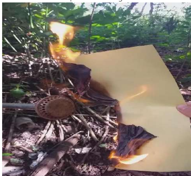
Figura 3. Teste de queima. “Boca” de fogão acoplado a mangueira em funcionamento demonstrando a queima do biogás
